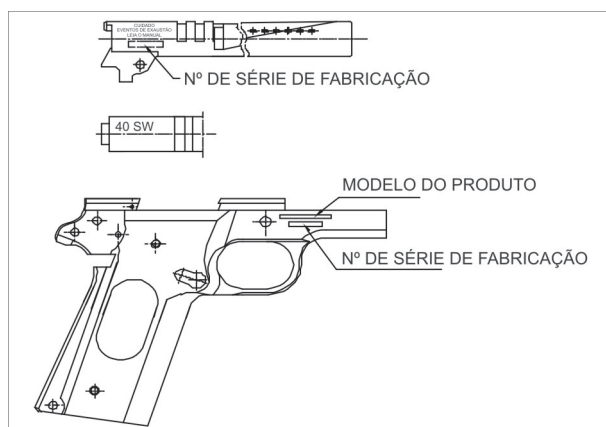
Figura 6 – Locais de gravação do número de série nas pistolas IMBEL (armas curtas).
